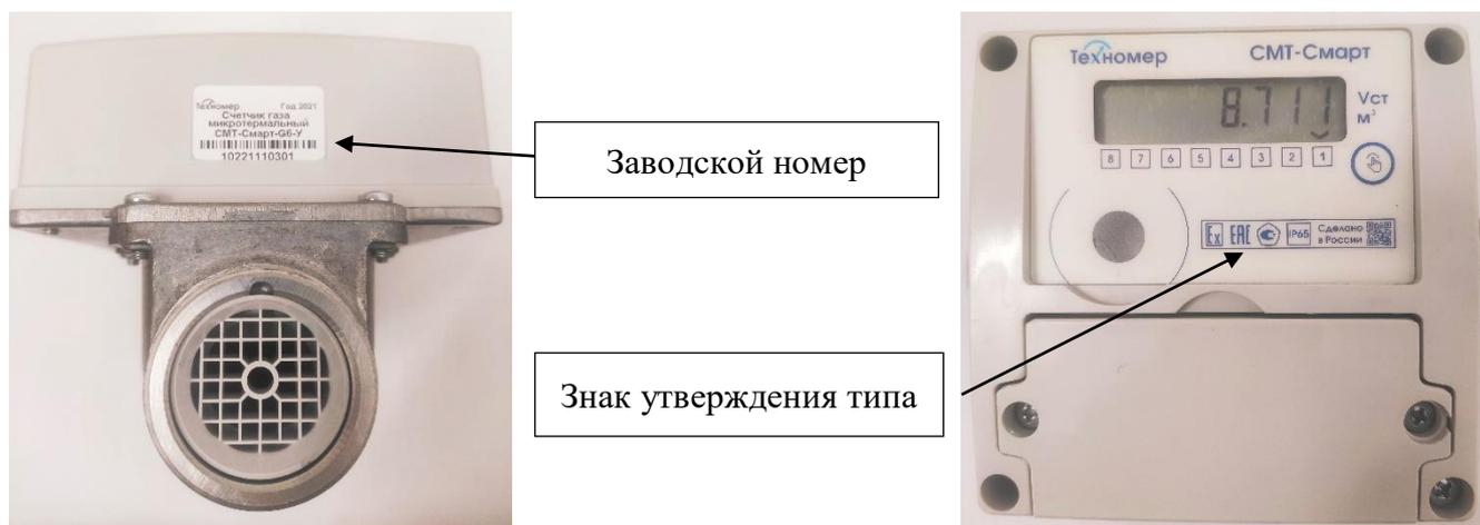
Рисунок 10 – Место нанесения заводского номера и знака утверждения типа
